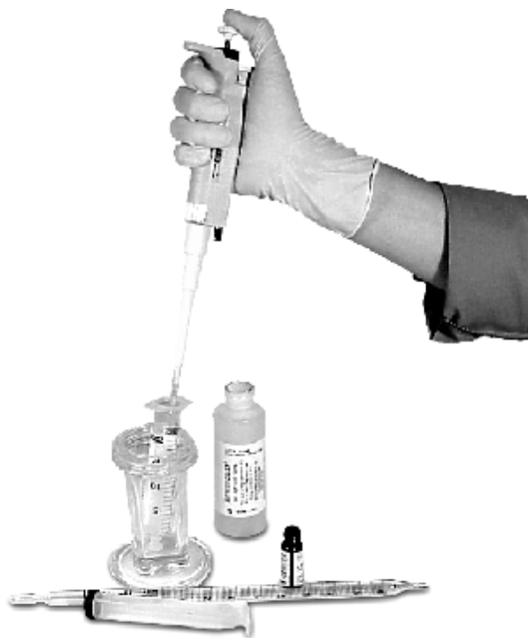
31. paveikslas. Perkėlimo švirkšto užpildymas
